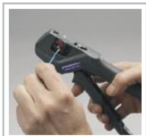
vstavljanje vodnika v kontakt
